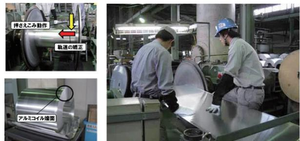
図1 作業員によるアルミコイルの端面揃え作業
